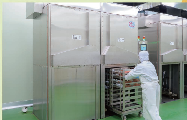
ソフトスチーム加工専用の機械。1台で80〜90kgの野菜の加工が可能。加工室でカットされた野菜が運ばれて蒸し加工が施される。蒸し上がった後に真空包装された商品は、再度表面の殺菌処理をこの機械で行われる。
