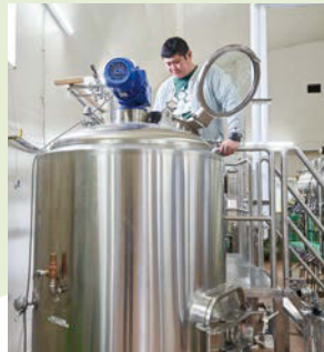
麦汁を製造する「仕込み」の工程には糖化・麦汁ろ過・麦汁煮沸があるが、ここでは麦汁煮沸の後にホールホップ除去の工程が加わる。
